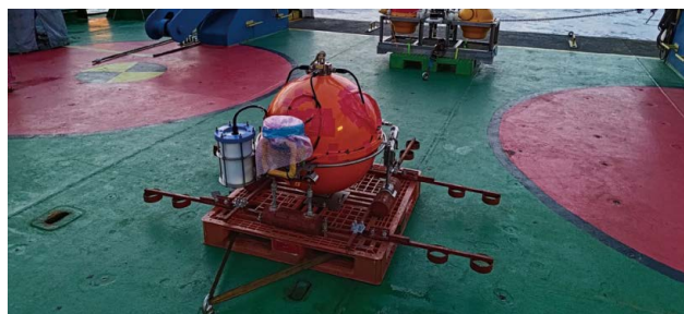
▲ 佈放來自東京大學的海底地震儀 (OBS) 與海底電磁儀 (OBEM)，達成國內佈放海床觀測儀東界的里程碑
