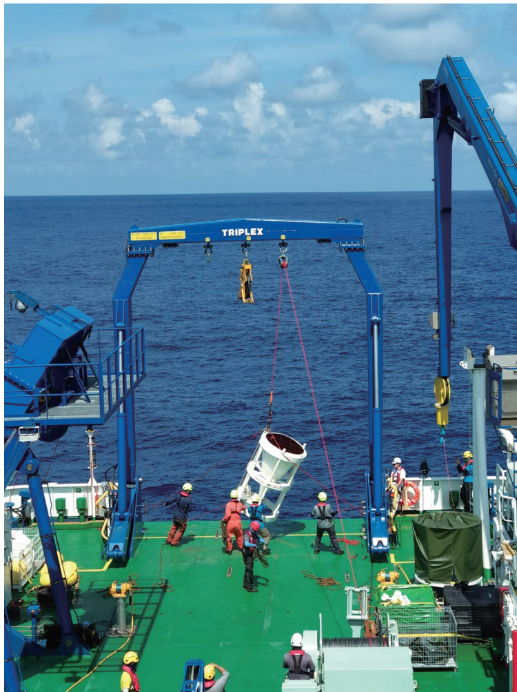
(圖 / 佈放沉積物收集器的錨碇串列)
